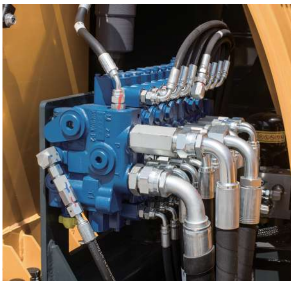
Válvula de controle principal no lado direito da cabine para redução de ruído e dissipação de calor.
