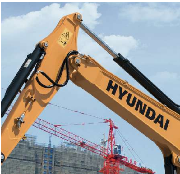
Tubulação de kit rompedor de série
